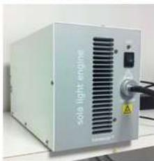
Module de fluorescence financé par l'association qui permet de visualiser des cellules des cellules cancéreuses à haute définition
